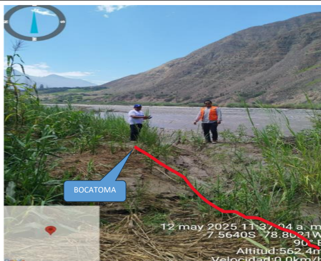
FOTOGRAFIA N° 1 Y 2 . TRAMO CRITICO EN EL RIO CHICAMA , EN LA TEMPORADA DE MAXIMAS AVENIDAS HACE DESASTRE Y DAÑOS A LA BOCATOMA DEL CANAL DE RIEGO EL EMPALME - ESPEJO , TERRENOS DE CULTIVOS Y CONSTRUCCIONES ALEDAÑAS AL RIO CHICAMA EN EL CASERIO COJITAMBO AGUAS ABAJO, VULNERABLE A LAS VELOCIDADES EROSIVAS DEL RIO
