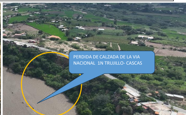
FOTOGRAFIA N° 7 Y 8 . EN LA TEMPORADA DE MAXIMAS AVENIDAS EL RIO CHICAMA, AH AFECTADO GRAN PARTE DE LA PLATAFORMA DE LA VIA TERRESTRE TRUJILLO - CASCAS , ADEMAS DE LA PERDIDA DEL UN TRAMO DE CANAL DE RIEGO CUYOS TRAMOS SE ENCUENTRA DESPROTEGIDO A DESLIZAMIENTO Y EROSIONES OCASIONADAS POR EL RIO CHICAMA EN EL CASERIO
